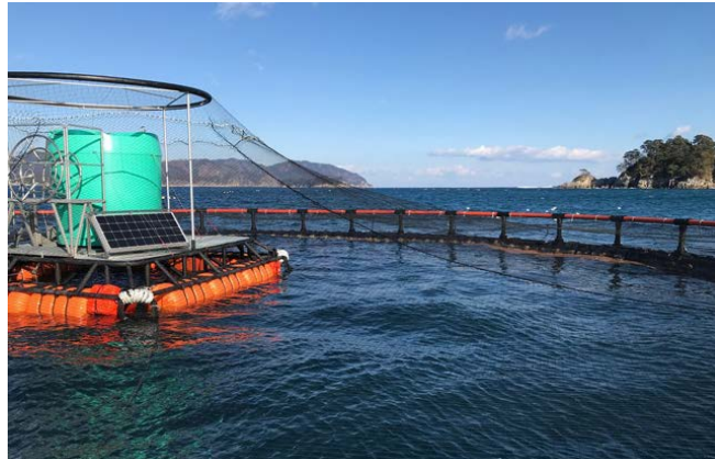
岩手県大槌町の「アクアリンガル®」給餌システム
