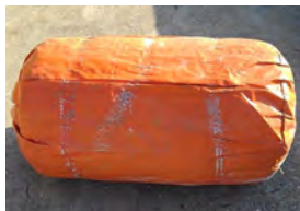
【切り替え前】ナイロンカバー発泡スチロール製フロート
