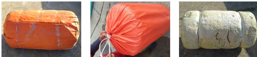
【切り替え前】ナイロンカバー発泡スチロール製フロート
