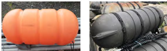
【切り替え後の例】PEコーティングされた発泡スチロール製フロート
