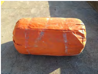
ナイロンカバー付き発泡スチロール製フロート
